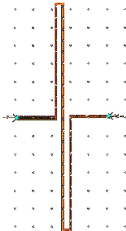
圖十一 利用 ADS 的 momentum 功能模擬電感之示意圖
