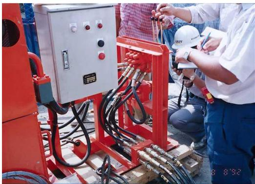
圖十三 油壓系統機組測試
