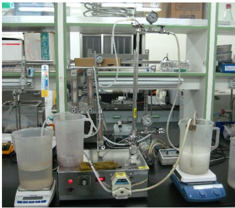
圖 3 管式膜過濾裝置照片
