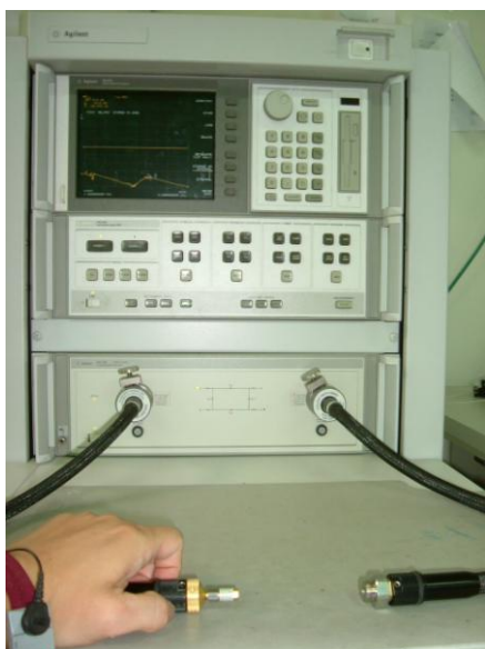
圖十六 使用網路分析儀(network analysis)做 Open、Short、Load 校正
