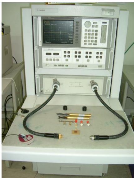
圖十五 網路分析儀、校正接頭、扳手等設備
