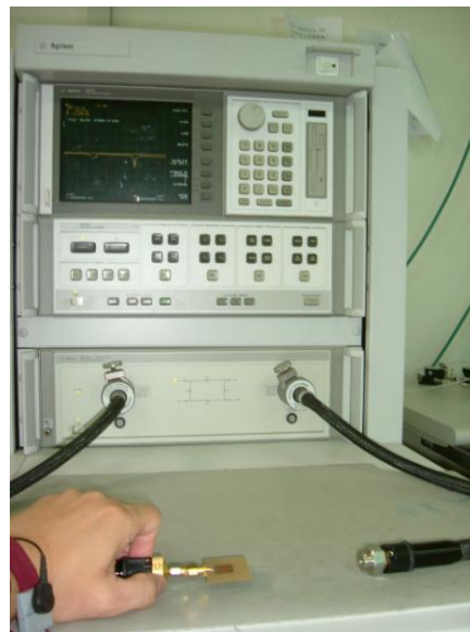
圖十八 接上待測天線進行 S11 之量測
