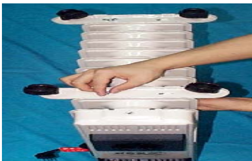
圖 2-2 用 U 型固定栓貫穿輪架
