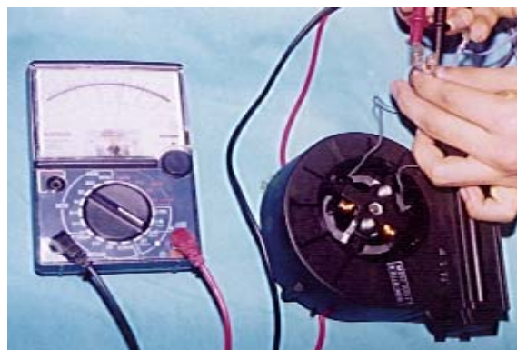
圖 2-35 測量馬達線圈有無斷路
