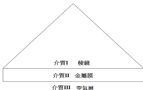
圖 3 Kretschmann 組態示意圖
