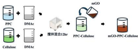
圖4 製備 PPC-Cellulose 及 GO PPC-Cellulose 溶液之實驗步驟
