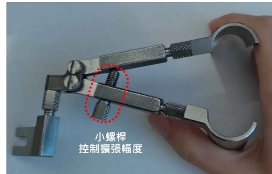
圖17 撐開器尾端關節示意圖
