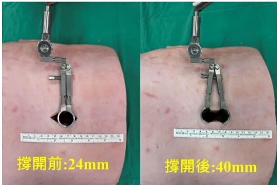
圖27 手術模擬過程其三，擴大完成後之切口，根據模擬之元件尺寸，我們將切口寬度調整至40mm
