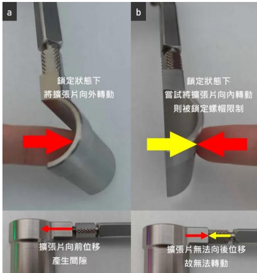
圖14 螺旋軸關節機構單向鎖定示意圖
