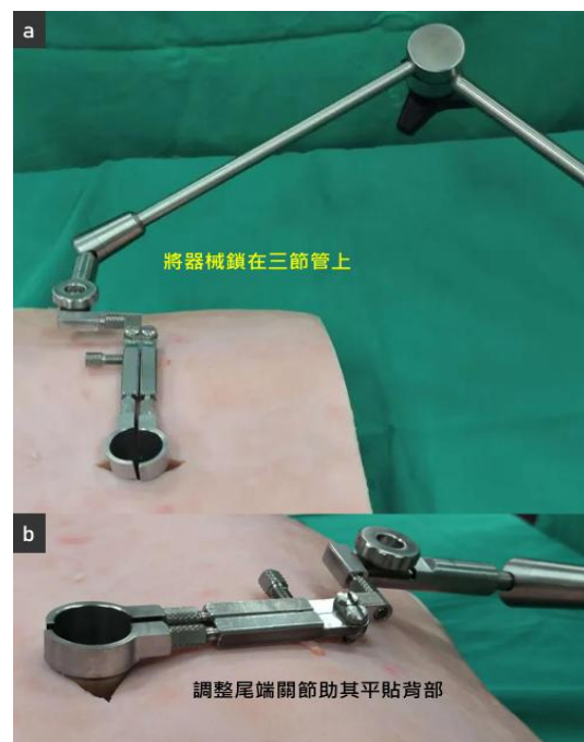
圖25 手術模擬過程其一，該步驟係將撐開器固定於與手術台連接之三節管上，並設定其平貼受試樣品表面。
